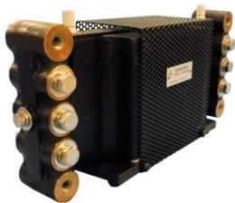
6623Aシリーズと併せてギルドラインは正確な高電流測定用に3種類の新しいDCシャントを製作しました。抵抗値10 $\mu$  のモデル9230A-3000は室内温度で1500Aまで、強制空冷装置92310を使うと3000Aまでの電流で使用できます。抵抗値5 $\mu$  のモデル9230A-5000は室内温度で2500Aまで、強制空冷装置92310を使うと5000Aまでの電流で使用できます。抵抗値1 $\mu$  のモデル9230A-10,000は室内温度で5000Aまで、強制空冷装置92310を使うと10,000Aまでの電流で使用できます。これらのシャントはギルドラインの58年以上に及ぶ精密シャントの開発と製造の結果生まれ、多くのユニークなデザインが組み込まれています。詳しくは9230A精密DCシャントデータシートを参照して下さい。
