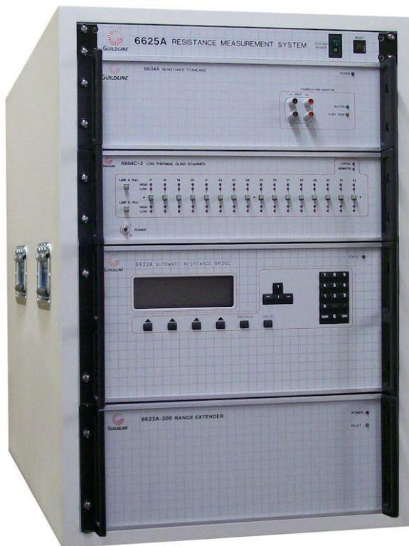
Guildlineの独自技術によりGuildline製品のユーザーはシャント測定能力の拡張において最高の品質と融通性を享受することができます。既存の多くのレンジエクステンダー製品とは異なり、6623Aシリーズはゼロから設計されました。この為、測定機能、サイズ、パワー処理等の改善だけではなく投資予算への考慮も払うことができました。例えば左の写真の6625A測定システムは単相の120VAC、15Aの電源で稼動し、高さ1メートル未満のサイズで、300Aで1  $\mu$  から1000Vで1Gまで測定できます。
